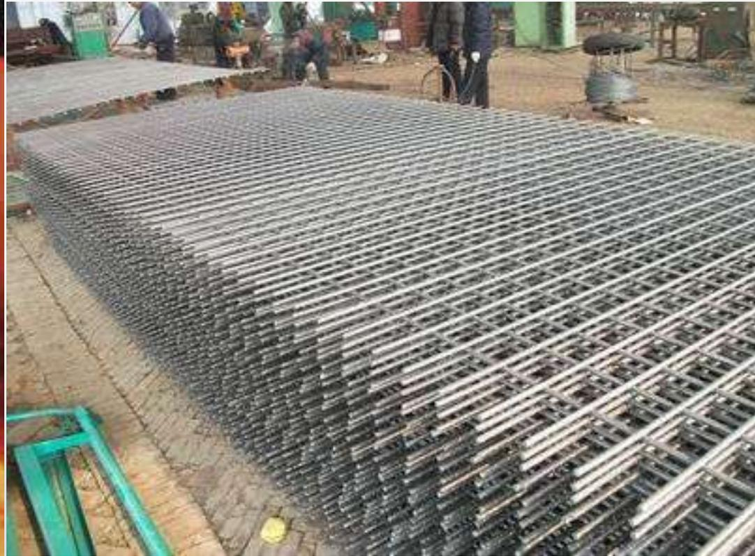
Su uso más frecuente es en el refuerzo de losas con sistema losacero y capas de compresión en losas aligeradas de concreto (Sistema Vigueta y Bovedilla). También se utiliza para reforzar firmes de concreto.
